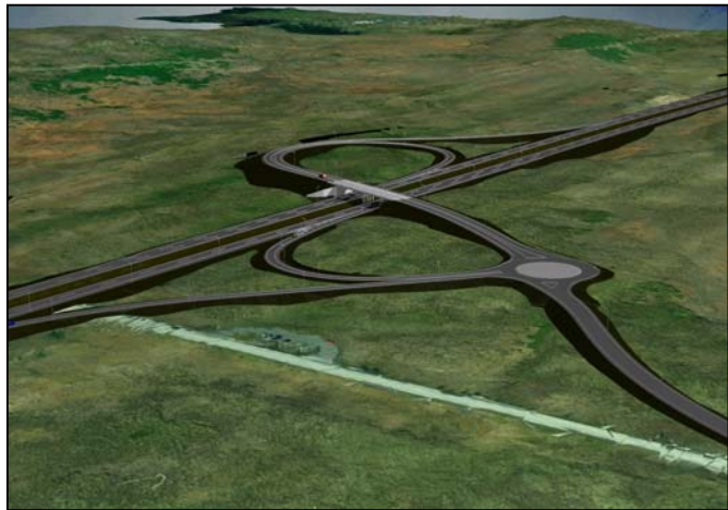
Mynd 5.5 Mislæg trompetvegamót við Grindavíkurveg, horft til norðausturs.
